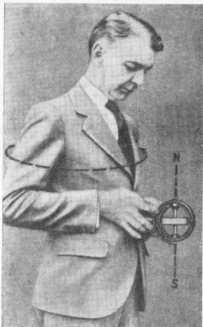
Рис. 17.11. Демонстратор играет роль земного шара (вращается вокруг оси) и притягивает к себе с ускорением гироскоп, демонстрируя принцип его действия.
